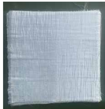
Defekte Faserlage mit Ondulation.
