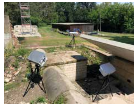
oben: LUPE+ Sensor mit additiv gefertigtem Gehäuse.
