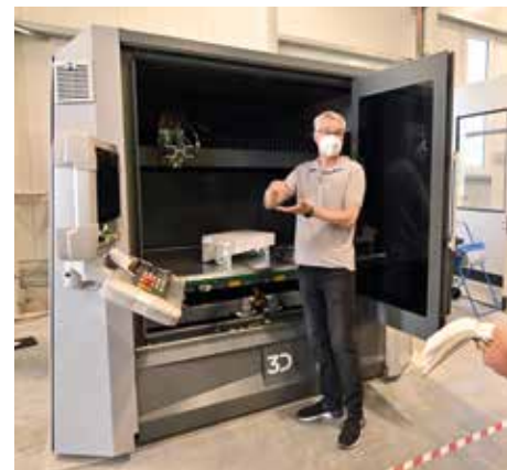
Die HAGE3D ermöglicht einen Druck sowohl mit Filament als auch mit Granulat. Der maximale Druckraum beträgt 1200mm x 1200mm x 1000mm im 3-Achs-Betrieb, während der 5-Achs-Betrieb erlaubt komplexe Bauteile ohne Stützmaterial zu drucken, was Zeit und Material spart.
